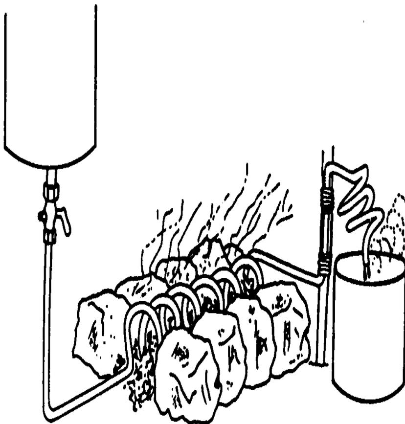
Este é outro método para purificar a água, através de um cano de cobre espiralado a água passa pelo cano no fogo quente, eliminando as impurezas.
