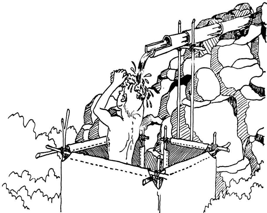
Uma calha feito com um bambú cortado ao meio, aproveitando uma queda d'água, servirá perfeitamente para improvisarmos um chuveiro.
